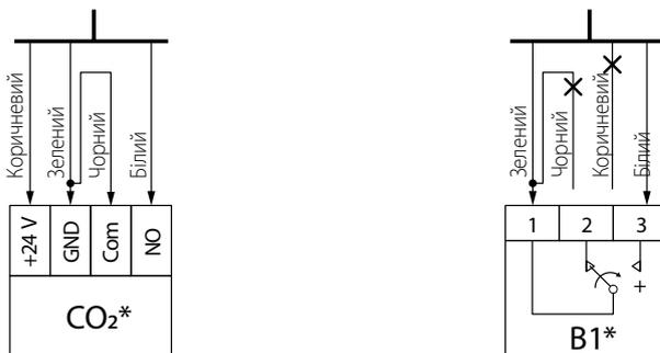
Підключення датчика до блоку керування здійснюється за допомогою кабелю, виведеного на кронштейн кріплення датчика.
