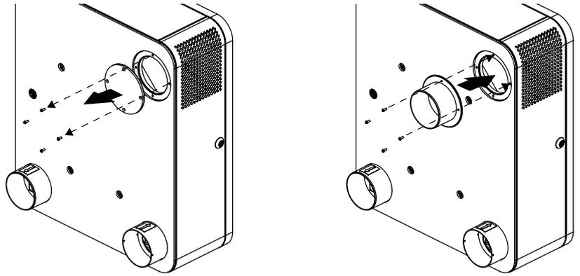
6. **Увага! Нагрівач підігрівання конденсату необхідно встановити перед фіксацією установки на стіні (див. посібник з монтажу нагрівача).**
