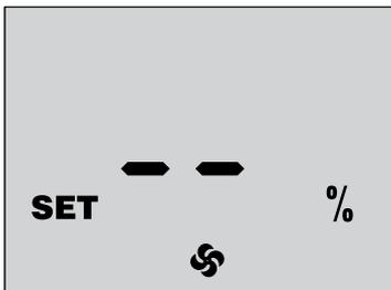
Після входу до режиму налаштування на дисплеї панелі керування відображається індикатор **SET** та **%**.
