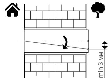
**4.** Заповніть порожнини між повітропроводами та стіною монтажною піною через спеціально передбачені технологічні отвори в шаблоні.
