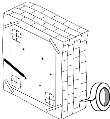
**2.** Зніміть шаблон і висвердліть два наскрізні отвори  $\varnothing$  120 мм для круглих повітропроводів.
