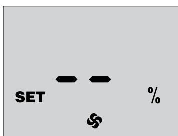
Після входу до режиму налаштування на дисплеї панелі керування відображається індикатор **SET** та **%**.
