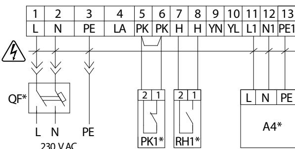
Підключення контактів пристрій здійснюється у блоці керування. Для доступу до блоку керування відчиніть дверцята виробу, відкрутіть гвинти, які фіксують зашивку, та зніміть її.
