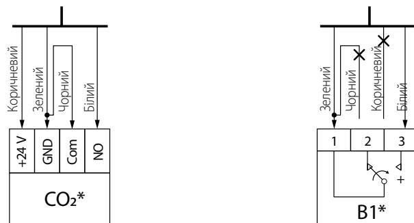
Підключення датчика до блоку керування здійснюється за допомогою кабелю, виведеного на кронштейн кріплення датчика.
