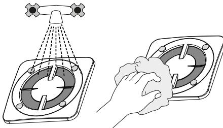
Очистити вентилятор м'якою сухою тканиною або пензликом.
