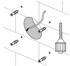
Встановіть вентилятор за допомогою шурупів. Підключіть вентилятор до мережі відповідно до схеми підключення.
