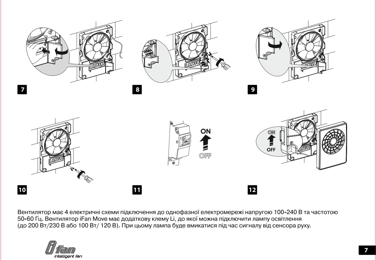
Вентилятор має 4 електричні схеми підключення до однофазної електромережі напругою 100-240 В та частотою 50-60 Гц. Вентилятор iFan Move має додаткову клему Li, до якої можна підключити лампу освітлення (до 200 Вт/230 В або 100 Вт/ 120 В). При цьому лампа буде вмикатися під час сигналу від сенсора руху.
