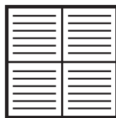
ОНК1, ОНК 3 – горизонтальне розташування напрямних повітряного потоку
