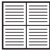
ОРК1 – паралельне розташування напрямних повітряного потоку
