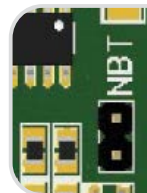
Рис. 5. Перемичка резистора мережевої шини
