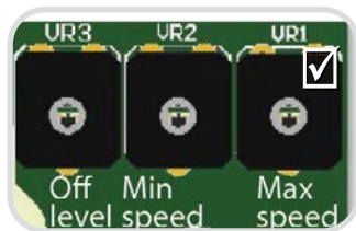
Рис. 6. Тример макс. швидкості
