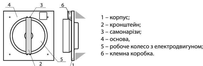
**Вентилятор серії ВЦ-ПК** складається з корпусу 1 із закріпленим всередині на кронштейні 2 електродвигуном з робочим колесом 3. Кронштейн 2 кріпиться до корпусу за допомогою чотирьох самонарізів 5. Зверху на корпусі кріпиться клемна коробка 4 для підключення вентилятора до однофазної мережі та розміщення робочого конденсатора.
