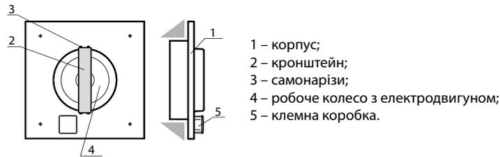
**Вентилятор серії ВЦ-ВН/ВЦц-ВН** складається з корпусу 1. Всередині корпусу на кронштейні 2 закріплено електродвигун з робочим колесом 3. Корпус прикріплено до основи за допомогою самонарізів 5. На корпусі зверху, з боку вхідного патрубку, закріплена клемна коробка 4 для підключення вентилятора до однофазної мережі та розміщення робочого конденсатора.
