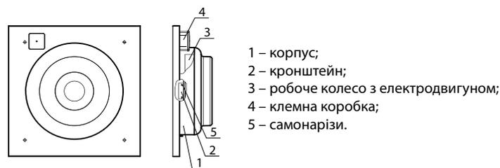
**Вентилятор серії ВЦ-ПН** складається з корпусу 1 із закріпленим на кронштейні 2 електродвигуном з робочим колесом 5. Кронштейн кріпиться до корпусу за допомогою чотирьох самонарізів 3. На вихідному отворі корпусу закріплена решітка. До верхньої частини корпусу з боку вхідного патрубку кріпиться клемна коробка 6 для підключення вентилятора до однофазної мережі та розміщення робочого конденсатора.
