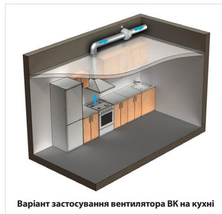
Варіант застосування вентилятора ВК на кухні
