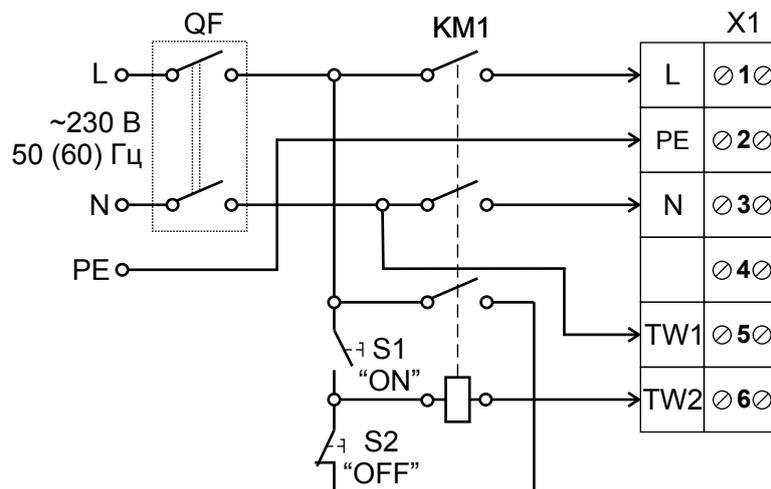
Клеми TW1, TW2 є виведеннями нормально замкнутого контакту термозахисту двигуна. Цей контакт повинен бути підключений послідовно до кола живлення котушки магнітного пускача KM1, який запускає двигун після натискання кнопки S1. У разі перегрівання двигуна контакт розривається та відключає котушку пускача, що призводить до знеструмлення та зупинення двигуна. Автоматичний вимикач QF, магнітний пускач KM1, кнопки керування S1 та S2 не входять до комплекту постачання і встановлюються споживачем.
