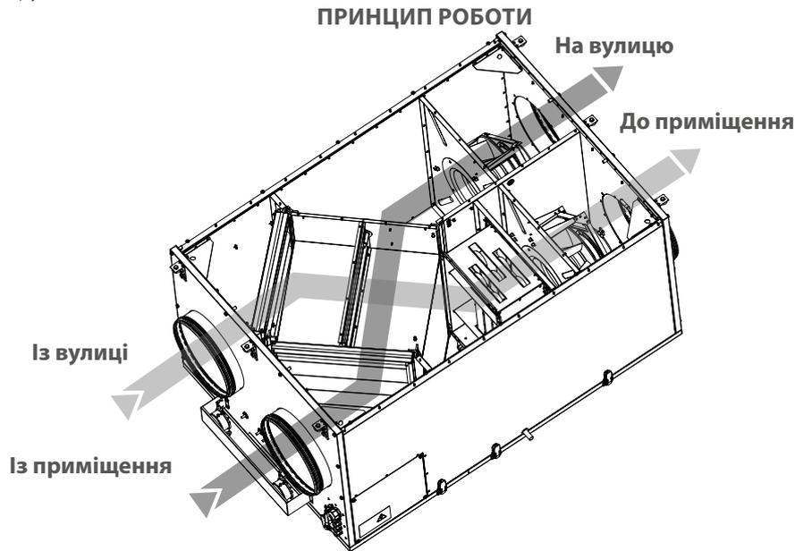
До конструкції установки входять припливний та витяжний відцентрові вентилятори однобічного всмоктування із загнутими вперед лопатками робочого колеса і ЕС-двигунами, які не потребують технічного обслуговування, із зовнішнім ротором та вбудованим тепловим захистом, пластинчастий протипотоковий рекуператор та електричний нагрівач.
