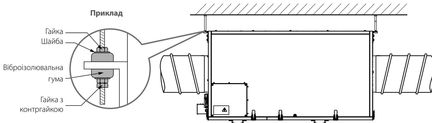
Для забезпечення найбільш ефективної продуктивності установки та зменшення аеродинамічних втрат, пов'язаних із турбулентністю потоку повітря, рекомендується на вході та виході з установки встановити прямий відрізок повітропроводу.
