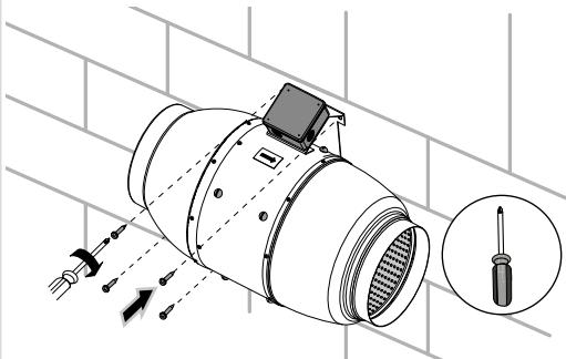
У будь-якому положенні: з обох боків вентилятора підключіть повітропровід.
