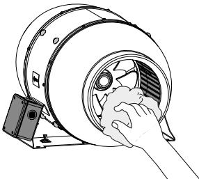
Очистити вентилятор м'якою сухою тканиною або пензликом.
